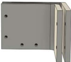
Con la cizalla de pedal corta dos rectángulos de 150 milímetros por 50 milímetros de la chapa de acero y después, usando la dobladora, dobla por la mitad en un ángulo de aproximadamente 90 grados, asegurándote de ir probando el ángulo en la pata de la silla de plástico. Además, haz 1 o 2 orificios para apretar las chapas con tornillos y tuercas en el extremo contrario al de la bisagra.
