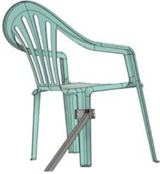
Con la bisagra, suelda las dos chapas metálicas para que se permita ubicar y retirar con facilidad de las sillas plásticas, por último, suelda el soporte de acero a la chapa, de manera que el soporte quede hacia atrás cuando se ubique en la silla.
