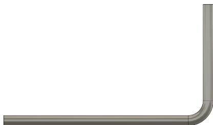
Corta una pieza de bisagra piano de 120 milímetros de largo, con la segueta. Luego, atorníllala a los tableros juntándolos por los lados que miden 200 milímetros. Toma la varilla de acero y córtala para tener una pieza de 400 milímetros. Luego, dobla la varilla a 120 milímetros con un ángulo de 90 grados para que resulte como la imagen de la izquierda.
